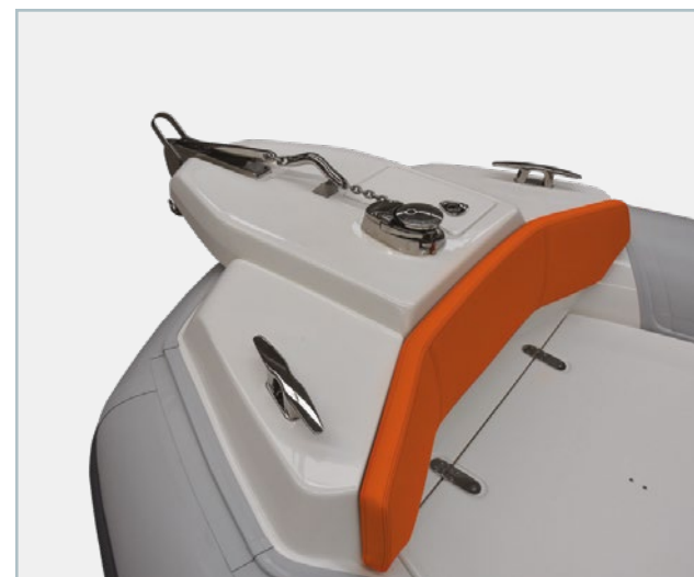
Option delphinrière en fibre avec guindeau, corde/chaîne et ancre inox
